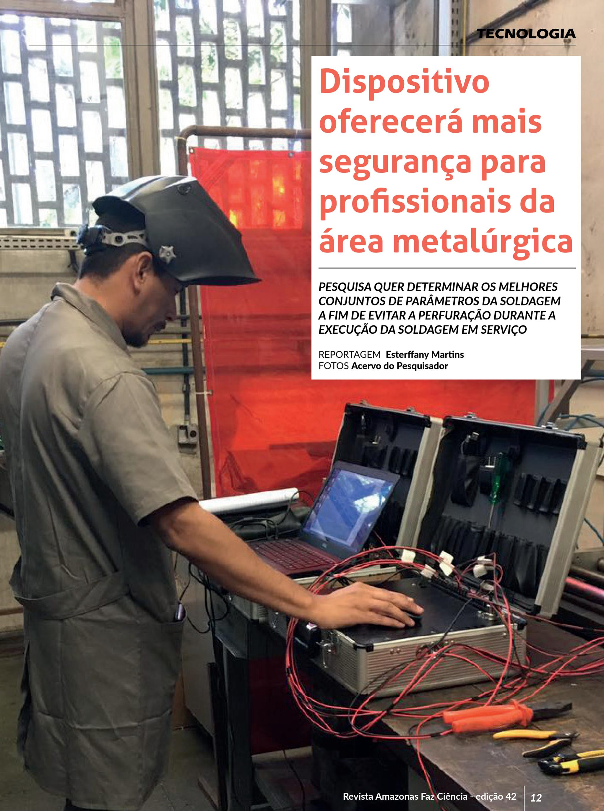
**UM DISPOSITIVO CAPAZ DE SIMULAR, COMPUTACIONALMENTE, O PROCESSO DE SOLDAGEM EM SERVIÇO ESTÁ EM DESENVOLVIMENTO PELO PESQUISADOR** e doutorando em Engenharia Metalúrgica e de Materiais, Antonio Alves. O equipamento reproduz a condição de soldagem em serviço utilizando a água como fluido que retira calor da chapa soldada. A pesquisa quer determinar os melhores conjuntos de parâmetros da soldagem a fim de evitar a perfuração durante a execução da soldagem.
