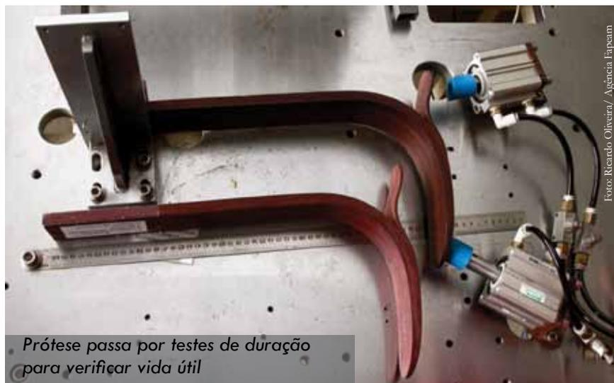
Prótese passa por testes de duração para verificar vida útil
